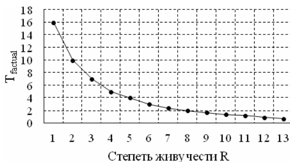
Рис. 3. Зависимость безопасного ресурса объекта от величины риска аварии на момент окончания его строительства
