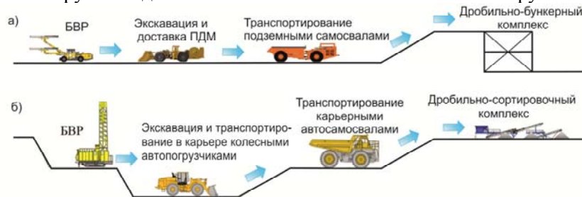
Рис. 1. Транспортно-технологические схемы добычи полезных ископаемых с использованием погрузочно-доставочных машин: а – погрузочно-доставочных машин в шахте; б – колесных автопогрузчиков в карьере
